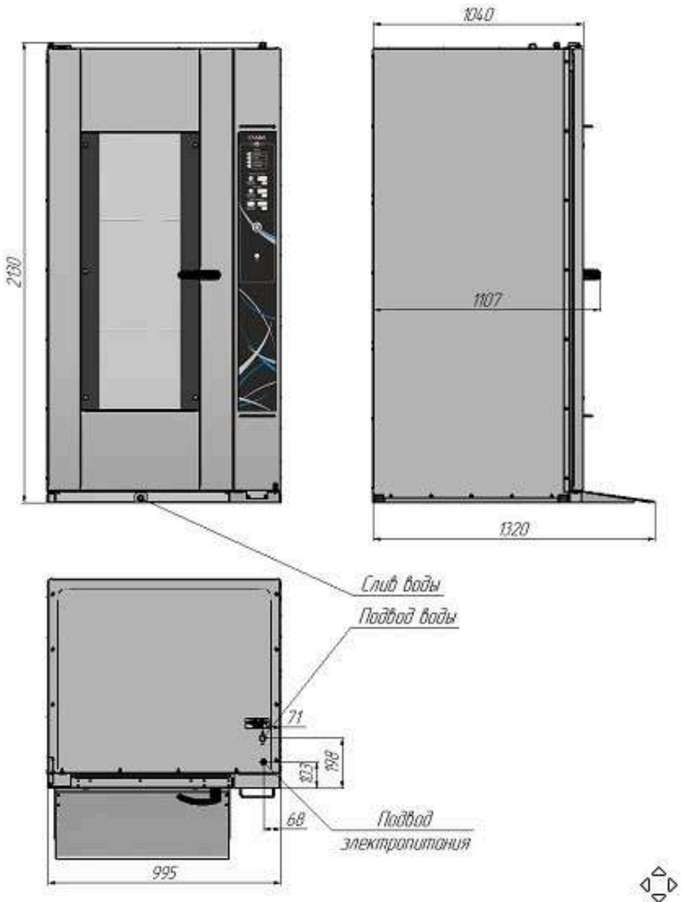
Рис.2 Шкаф расстоечный тепловой ШРТ-18П.
